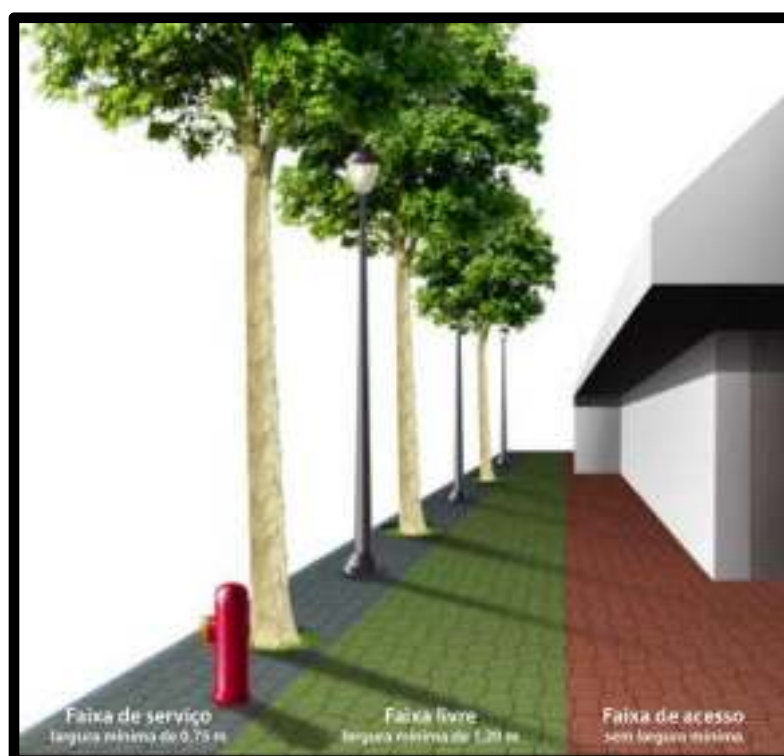
Foto 13: Dimensões adequadas para faixa de vias públicas (Fonte: Guia prático para a Construção de Calçadas)
