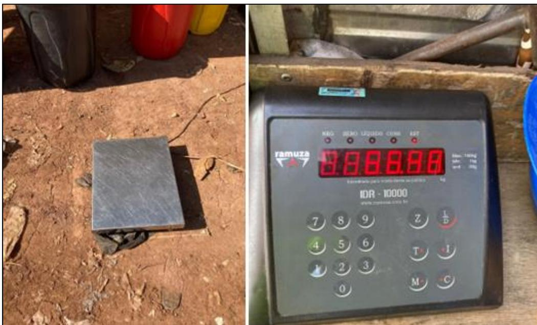
Figura 23 - Balanças para aferição da massa conforme a separação dos tipos dos resíduos sólidos urbanos.
