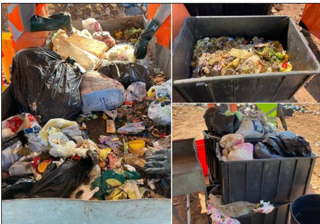
Figura 22 - Mistura dos montes selecionados no quarteamento, visando obter homogeneização da amostragem.
