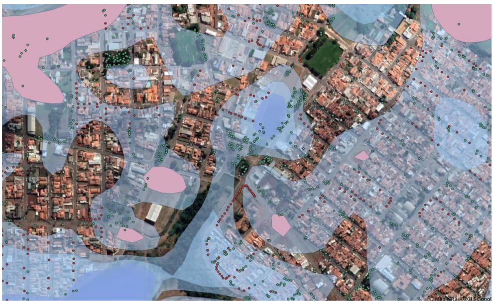
Engenheiro Coelho e suas temperaturas de superfície indicando áreas para serem arborizadas onde existem maiores temperaturas (cor quente)
