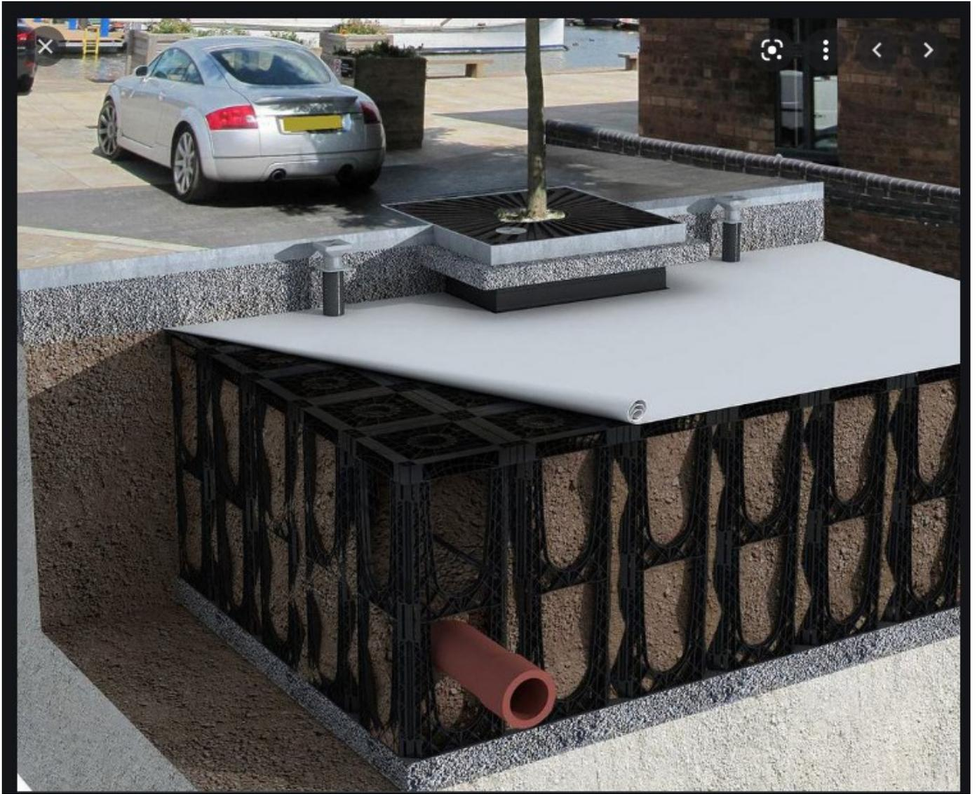
Existem alguns sistemas que sustentam o solo sem compactação para possibilitar o desenvolvimento pleno de raízes e ainda garantir uma excelente infiltração de água no local e garantindo uma excelente microdrenagem. Esses sistemas ainda não foram usados no Brasil.
