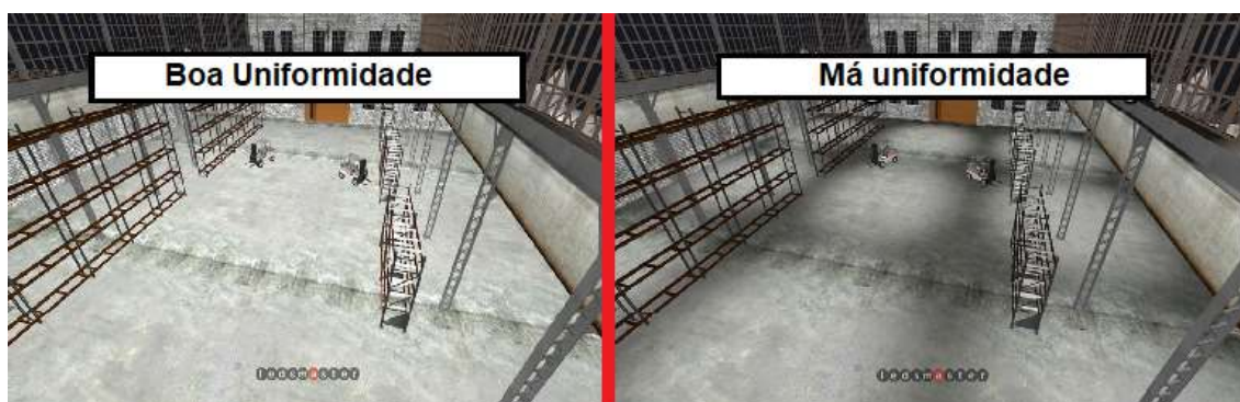
Figura 5.2 – Demonstrativo de boa e má uniformidade.
