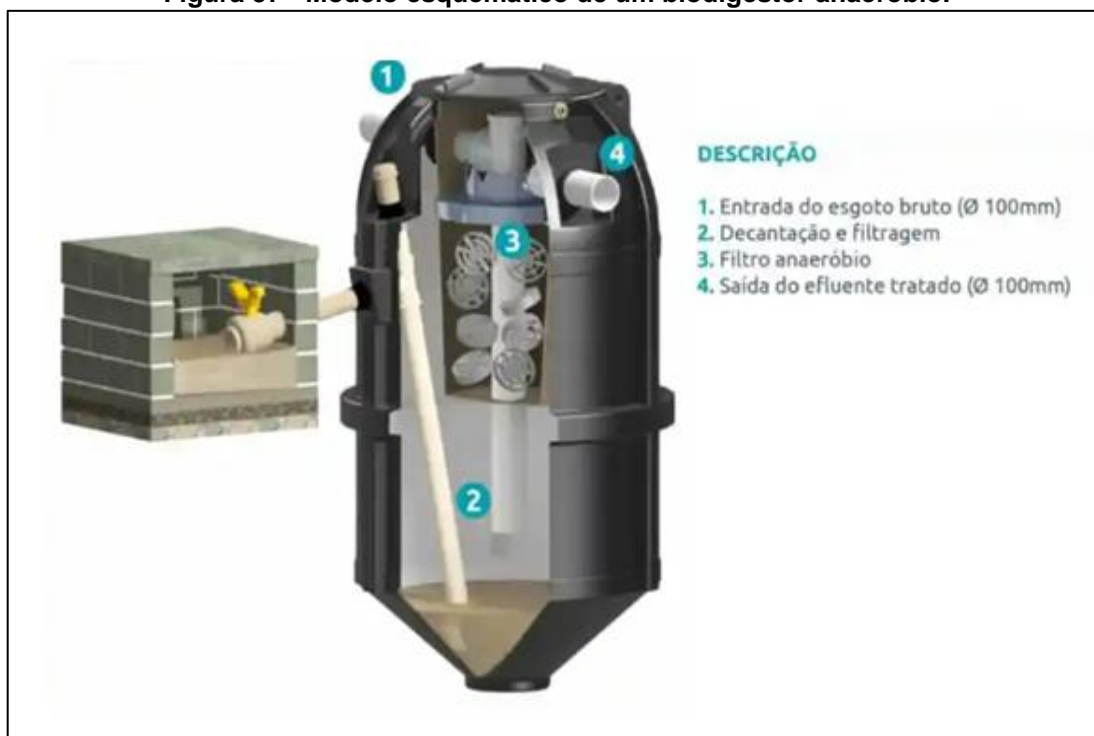
Figura 57 - Modelo esquemático de um biodigestor anaeróbio.
