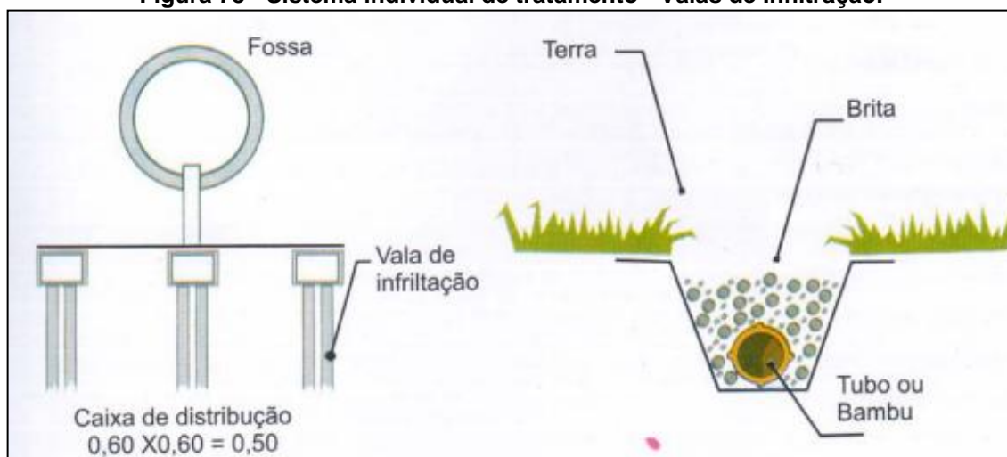
Figura 78 - Sistema individual de tratamento - Valas de Infiltração.
