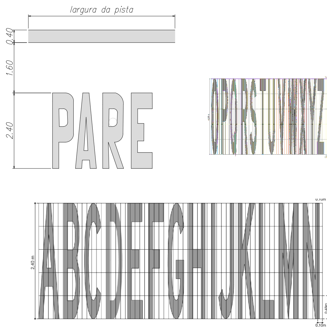
SINALIZAÇÃO HORIZONTAL SEM ESCALA
